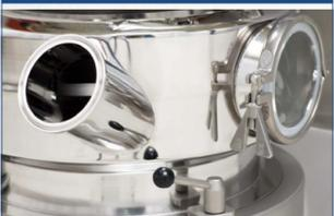
+ Der TC-Einlass kann 360° zum TC-Auslass rotiert werden. Dies ermöglicht eine problemlose Ausrichtung des Entstaubers am Auslass der Tablettenpresse
