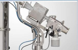
+ Wasserzuführungen für die Waschsequenzen des Entstauber-Innenraumes und der Peripheriegeräte sind vollständig in der Metalldetektorsäule integriert
