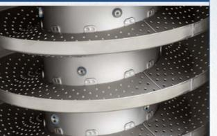
+ Wendelrohr mit integrierten Kegeldüsen, welche für einen geringen Wasserverbrauch von unter 50l/min ausgelegt wurden
