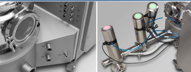
+ Die Anschlusspanels bieten eine optimale Möglichkeit, um die Medien Wasser, Luft sowie die Sensorik anzuschliessen
