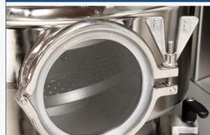
+ Die Sichtfenster am Entstauber gewährleisten stets eine optimale Einsicht auf die Wendel und erlauben somit jederzeit eine visuelle Kontrolle des Produktionsprozesses
