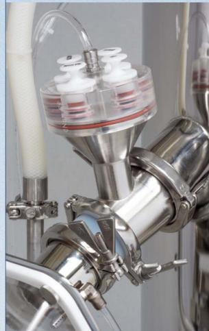
+ Die Einführung von Testtabletten mit dem KT2010 Testtabletten-Einwurfssystem ermöglicht das Testen des Metalldetektors auch unter High-Containment Bedingungen
